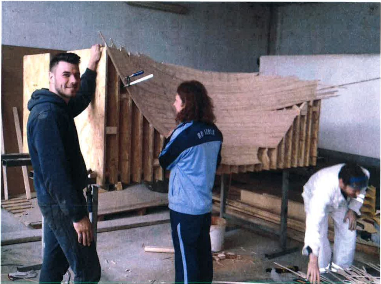
Slika 1 osnovna izdelava ogrodja kalupa. Na sliki so razvidni profili reber na katera so zalepljene lesene letvice (vzdolžno) , Tehnol d.o.o, Izola
