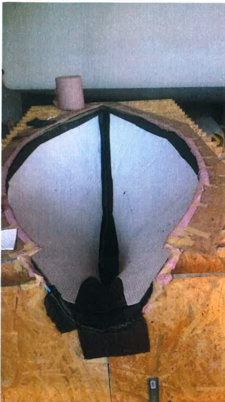
Slika 4 postavitev karbonskih vlaken za infuzijo, Tehnol d.o.o, Izola
