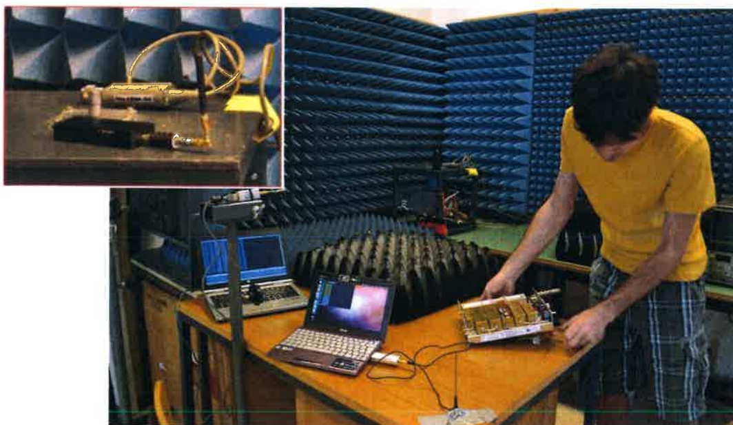
Sočasna laboratorijska meritev vpliva motilnika (v okviru) z obema v projektu izdelanima napravama: levo z detektorjem v fazi preizkušanja programske opreme (Raspberry-pi je zamenjal prenosnik)
