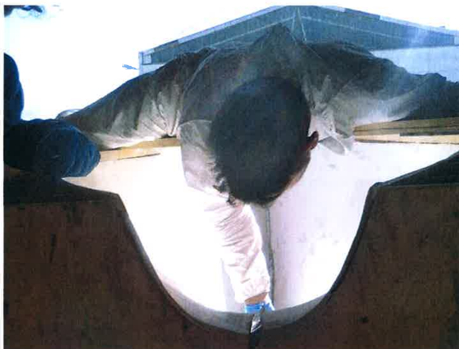
Slika 2 proces kitanja - cepljenje dveh polovic in kitanje srednjice za vakumsko zmogljivost kalupa, Tehnol d.o.o, Izola
