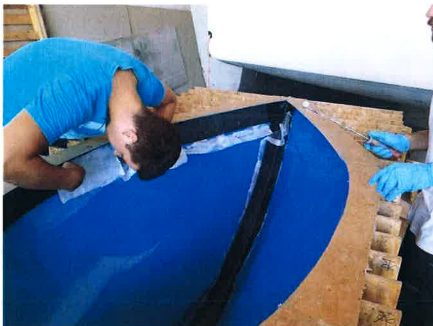
Slika 3 ročna laminacija robov na gladko dokončan kalup z nanešenim sistemom voskanja, Tehnol d.o.o, Izola
